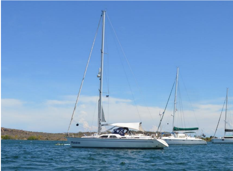
(Foto: Frank Reinecke) Der Ankerball ist gut sichtbar angebracht und signalisiert ein Boot vor Anker liegend.
