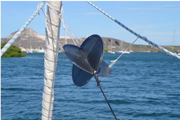
(Foto: Frank Reinecke) Der Ankerball ist an vier Punkten befestigt. So dreht er sich nicht ständig bei Wind und die Leinen Schamfilen nicht.
