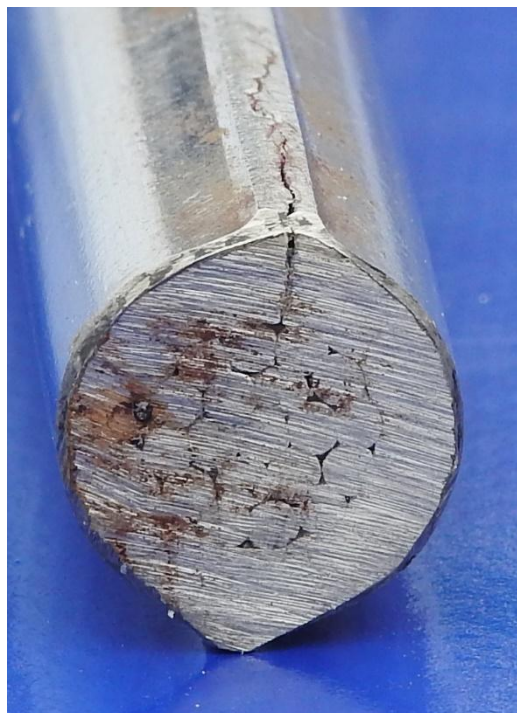
Hier ist das Terminal an der Walz Nut komplett gerissen
