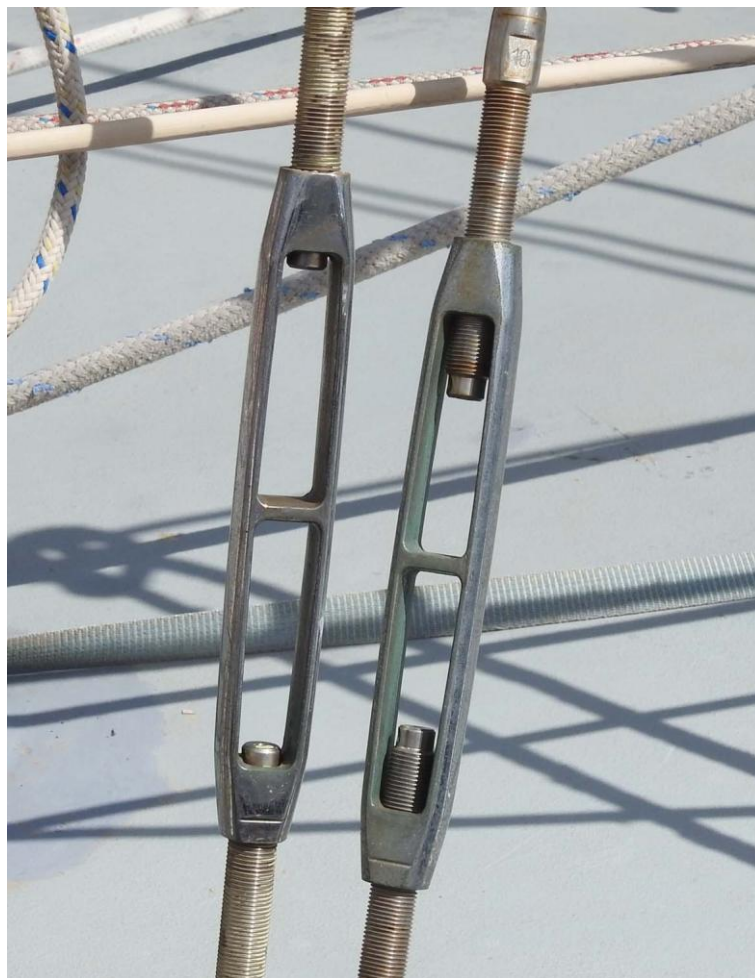
Hier fehlen die Sicherungssplinte und die Wante links ist zu kurz
