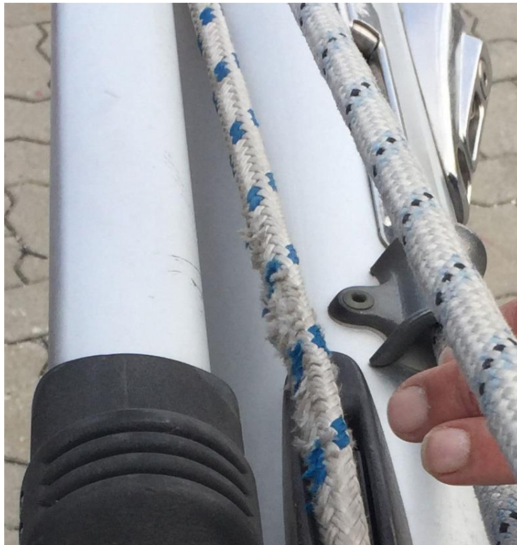
Dieses Fall muss ausgetauscht werden.
