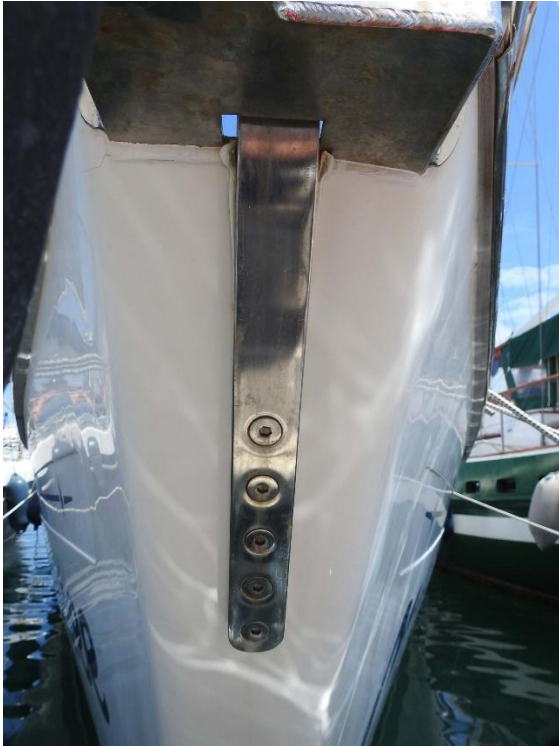
Der Beschlag des Vorstag ist von außen und innen zu kontrollieren
