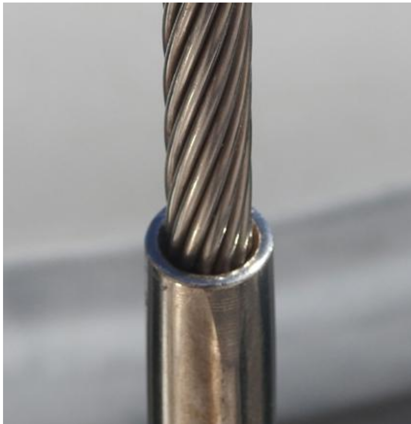
Der Übergang vom Draht in das Terminal ist besonders anfällig für Korrosion
