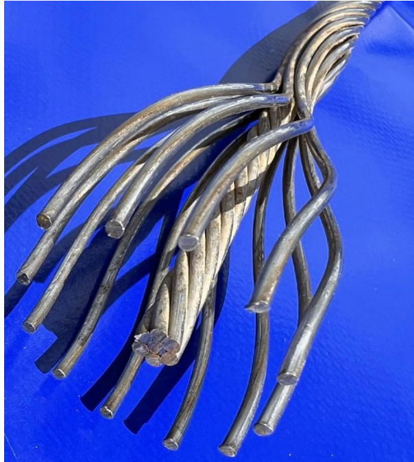
1x19 Drahtseil aufgeschnitten und aufgedreht, die gegenläufige Drehung der inneren 6 Kardeelen und der äußeren 12 Kardeelen sind hier sehr gut zu sehen
