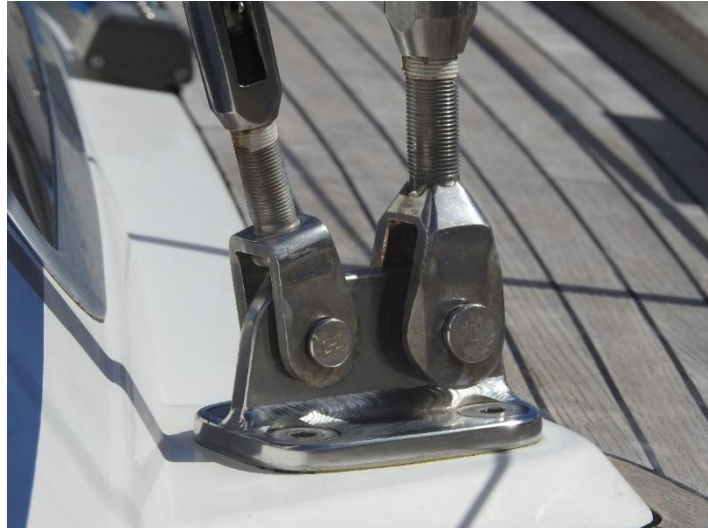
Ein Pütting Anschlag auf dem Deck mit Laminatverstärkung ohne Mängel
