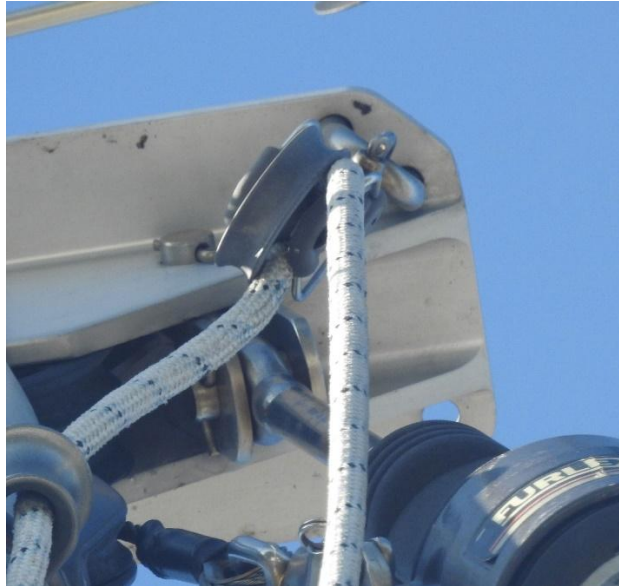
Eingeklemmtes Fall in einem Block am Masttop
