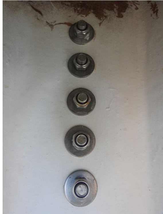
Der Beschlag des Vorstag ist von außen und innen zu kontrollieren
