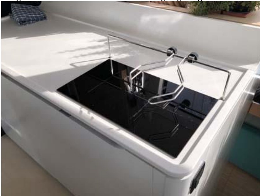
Foto (Frank Reinecke): Ein fest eingebauter 2-Flammen-Induktionsherd auf einem Katamaran
