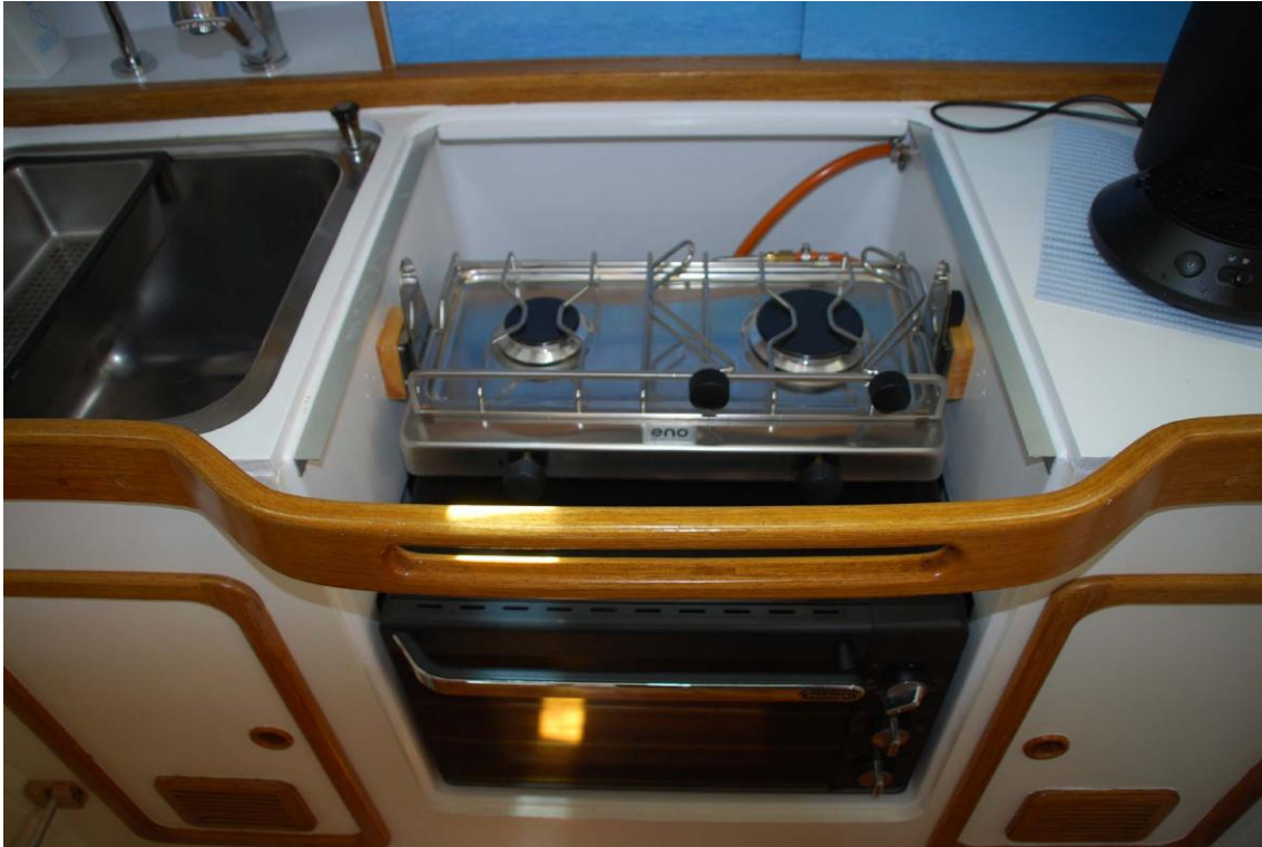
Foto (Frank Reinecke): Diese Pantry ist für die Passagen noch mit einem kardanisch gelagerten Gasherd ausgerüstet
