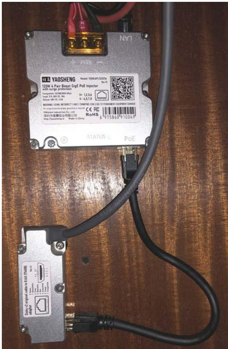
Die Installation auf der Manatee mit einem Adapter für das Starlink Dishy Version 2 Antennenkabel auf RJ45.
